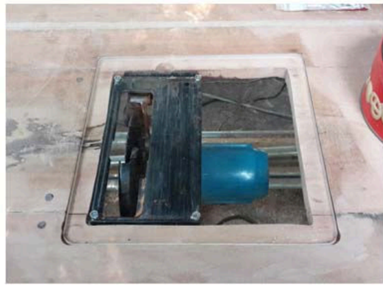
ภาพที่ ๓ : ผังแผ่นอะคริลิกสำหรับติดตั้งเลื่อยวงเดือนและเครื่องเร้าเตอร์แนวตั้ง
