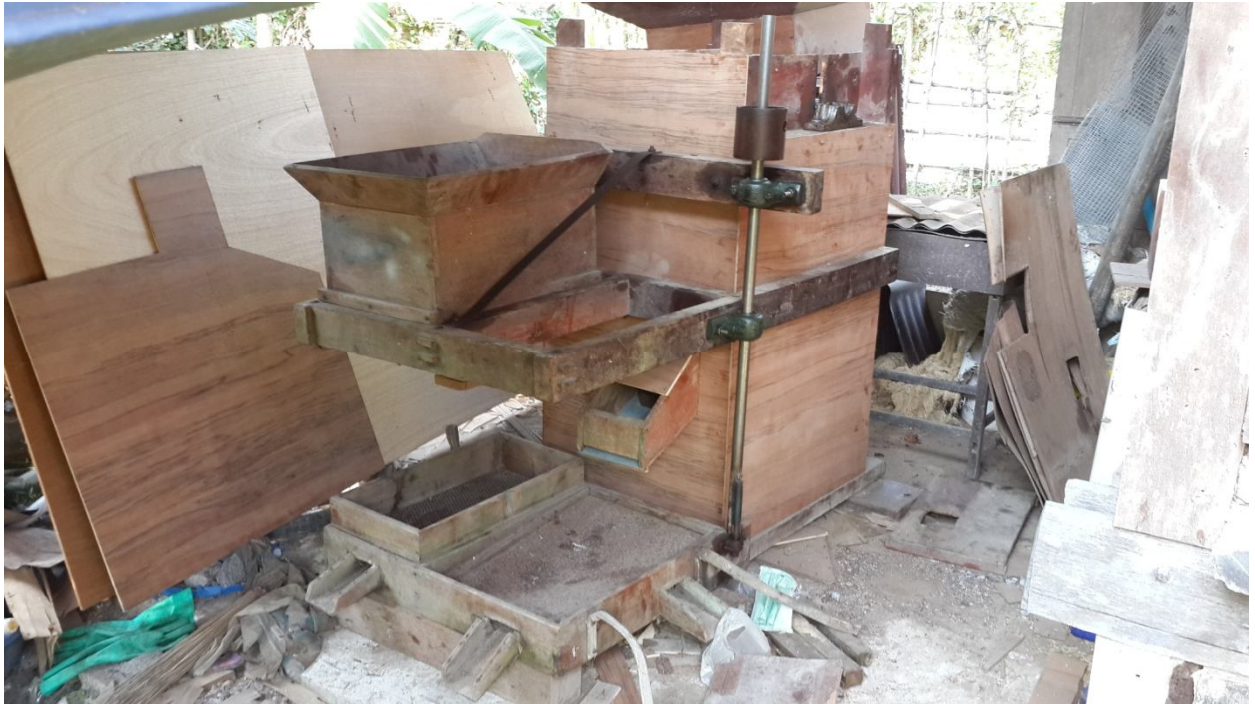
ภาพสีตูซึ่งซ่อมแซมปรับปรุงส่วนสำคัญแล้ว
